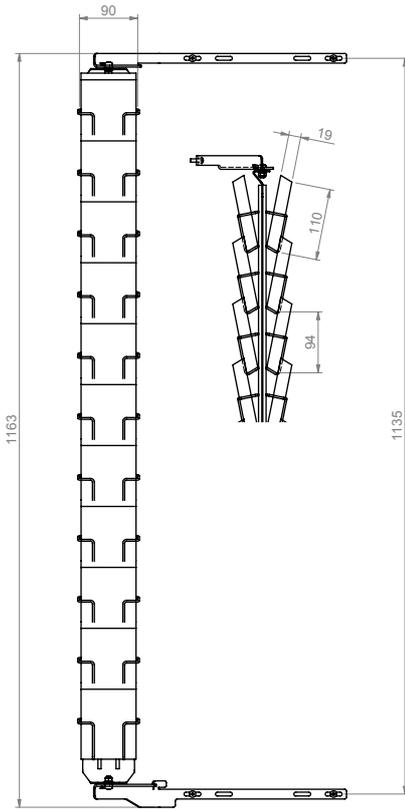
**23 | Drehbare Eckleiste f. Magnete (28 Fächer)**
